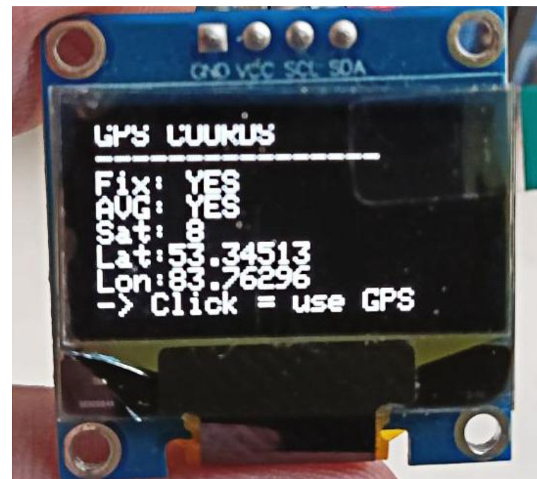
Полученные усреднённые координаты ГНСС и готовность к запуску радиомаяка
