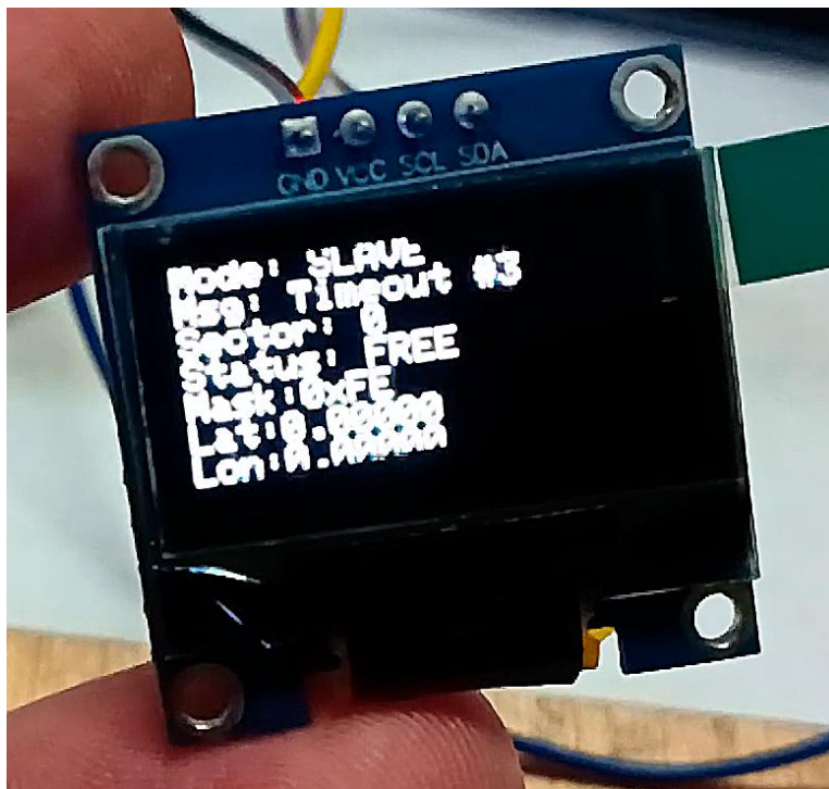
Таймауты в измерении расстояния радиомаяком в случае разворота БПЛА
