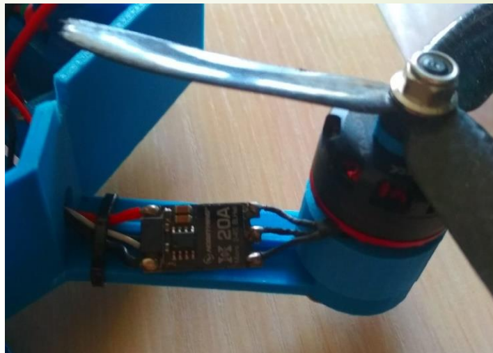
Рисунок 6 – Регулятор оборотов установленный на квадрокоптер
